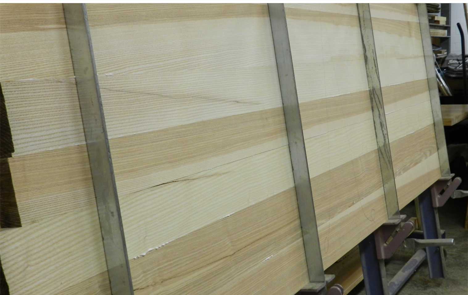
Bodenplatte wird verleimt. Zu beachten: das untere Brett ist in der Farbe passend zur Front
