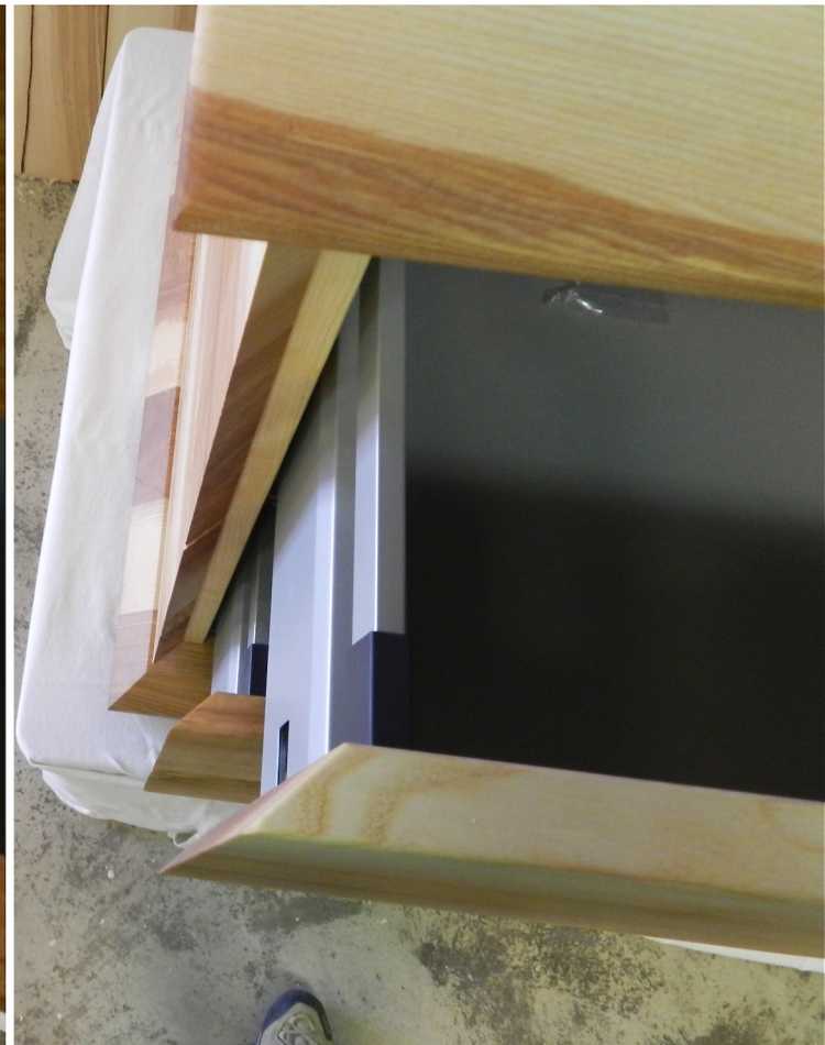
Links: Möbelerückseite. Oben: Gelungenes Detail - Schubladenfront und Seitenwand auf Gerung.
