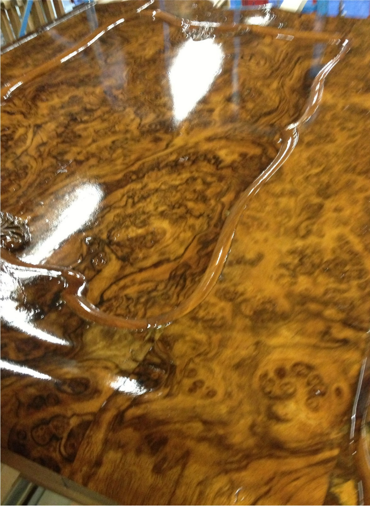
2. und 3. Auftrag des Gellacks
